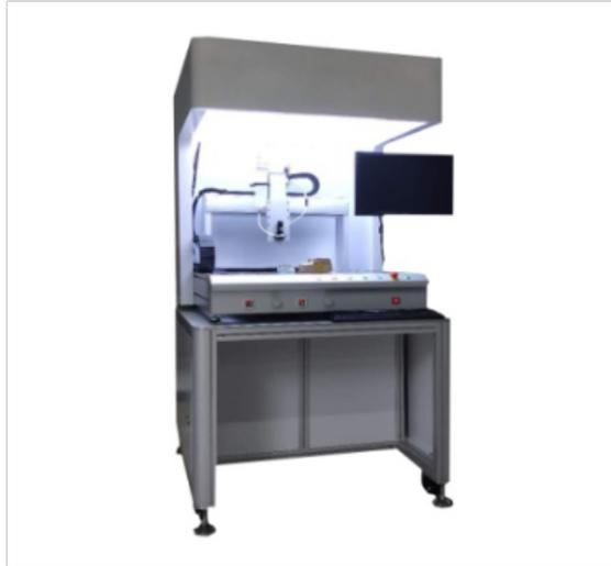
视觉点胶机又称涂胶机、滴胶机、打胶机、灌胶机等，专门对流体进行控制。视觉点胶机工作原理：压缩空气送入胶瓶（注射器），将胶压进与活塞室相连的进给管中，当活塞处于上冲程时，活塞室中填满胶，当活塞向下推进滴胶针头时，胶从针嘴压出。滴出的胶量由活塞下冲的距离决定，可以手工调节，也可以在软件中自动控制。视觉点胶机的特点：高速度、对胶剂粘度的低灵敏度。视觉点胶机的优势：可提高点胶速度，改善点胶环境，提高点胶质量。如果长时间不用一定要把胶打光，不然凝固在视觉点胶机里面，又要钱清理，非常麻烦。金华尚纳点胶机厂商
